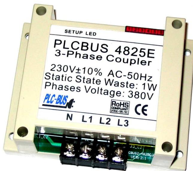
Ce module est un coupleur de phase permettant dans une installation triphasé de renvoyer un ordre PLCBUS reçu sur une phase vers les 2 autres phases.
